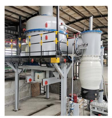
不锈钢无缝盘管专用真空光亮退火 炉,用于外径38mm-25mm盘管的 热处理,-196°液氮冷却
