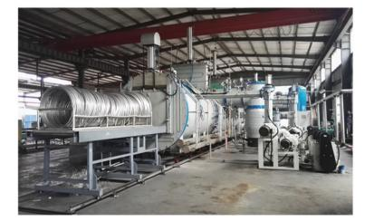
不锈钢无缝盘管专用真空光亮退火炉, 用于外径20mm-4mm盘管的热处 理, -196°液氮冷却。
